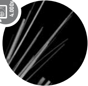
Asbestmonster 4000x (Scanning Elektronen Microscopie)
